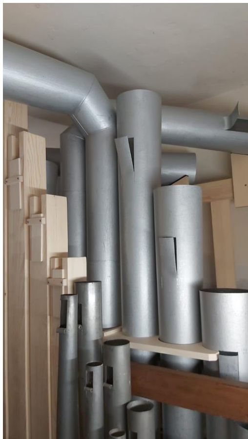
Nebenwerk und Pedal: Vorne links Teil der rekonstruierten Holzpfeifen des Geigenprinzips. Dahinter die rekonstruierten Zinkbecher der Posaune
